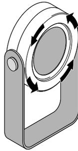
Drehen Sie den Gehäusering des Leuchtschirms zum Entriegeln gegen den Uhrzeigersinn bis zum Anschlag.
