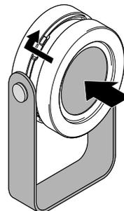
Drücken Sie den Leuchtschirm bis zum Anschlag zusammen und drehen Sie den Gehäusering zum Verriegeln im Uhrzeigersinn bis zum Anschlag.
