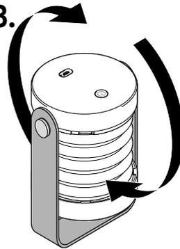
Drehen Sie den Leuchtschirm in die gewünschte Position. Der Leuchtschirm ist um 360° schwenkbar.
